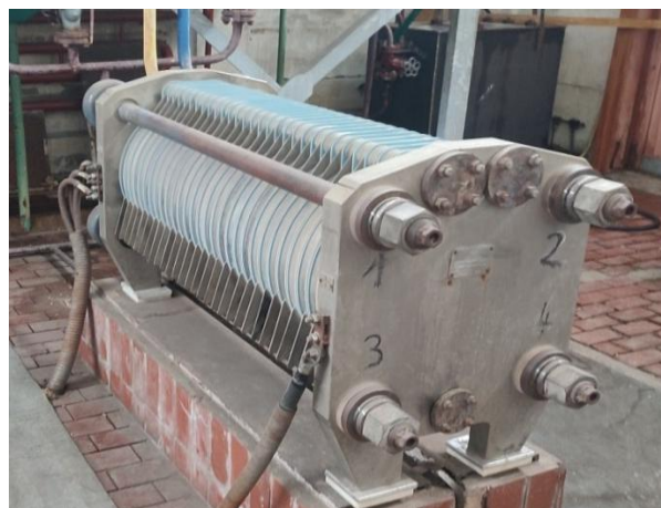
Слика 1. Изглед алкалног електролизера
